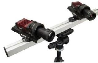
*Système de mesure par stéréocorrélation*
