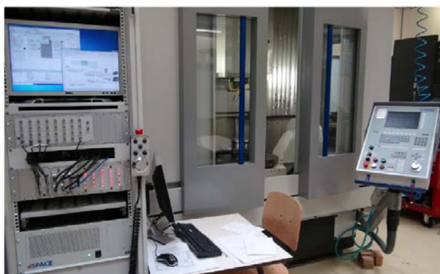
Centre de fraisage Mikron UCP 710 et la commande numérique PREMIUM Open-CNC
