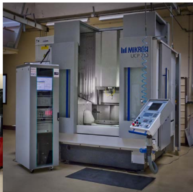
Centre de fraisage Mikron UCP 710 et la commande numérique PREMIUM Open-CNC
