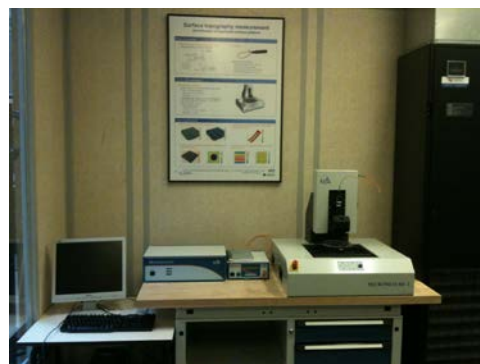
Crayon de mesure et station de micromesure Stil
