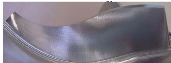
Trajectoire de fraisage 5 axes optimisée
