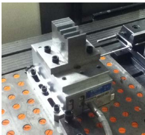
Platine dynamométrique à quartz Kistler 9265B et amplificateur de charge 5070A
